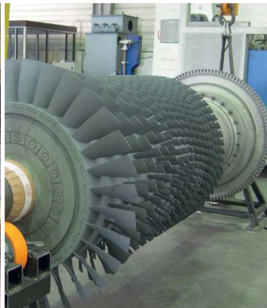
Projection HVOF sur rotor de turbine
