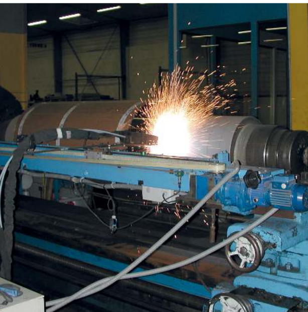
Projection Arc électrique sur portées
