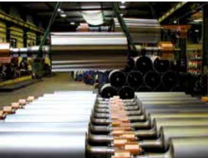
Rouleaux conducteurs pour ligne d'étamage électrolytique
