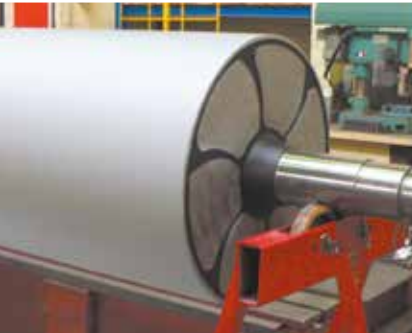
Rouleau finition mate pour une ligne laminating
