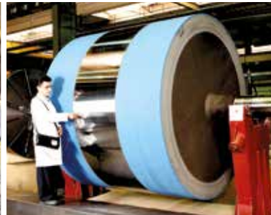
Rouleau conducteur pour ligne d'électro galvanization
