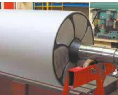
流延线及挤出复合线毛面、雾面辊
