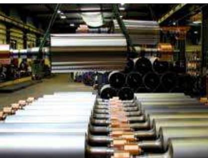
电镀锡生产线导电辊
