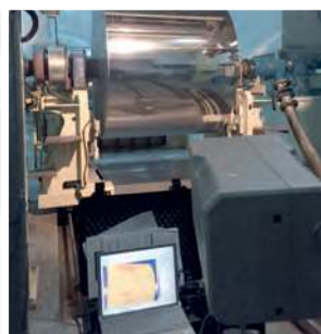
Control por cámara térmica
