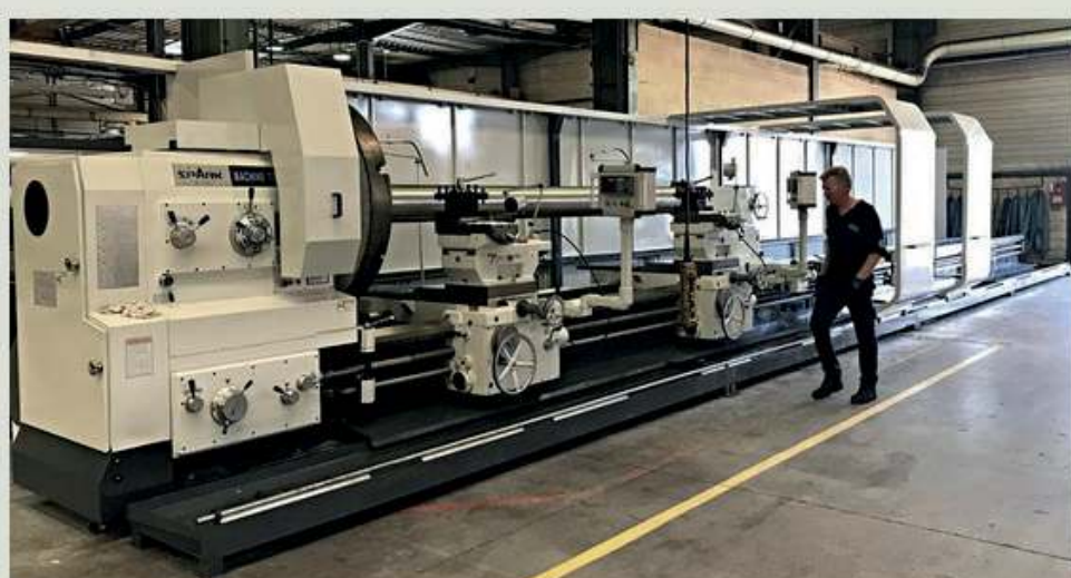
PMG POLIMIROIR : Installation d'un nouveau tour de 15 m de longueur.
