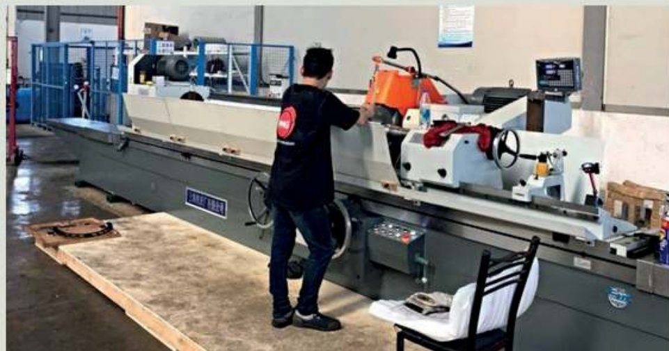
PMG WUJIANG POLIMIROIR : Mise en place d'une unité de rectification de moyennes dimensions et nouvelle cabine plasma pour les rouleaux.
