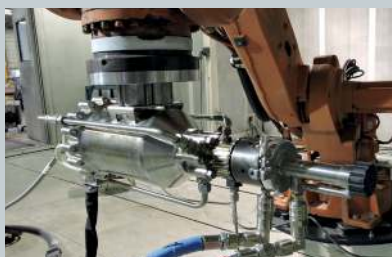
威斯科汀的冷喷涂技术处理的表面铜致密沉积（孔隙率<0.2%）
