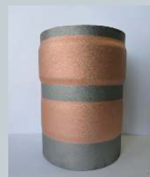
威斯科汀的冷喷涂技术处理的表面铜致密沉积（孔隙率<0.2%）
