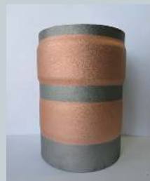
Dépôt dense (porosité < 0,2 %) de cuivre réalisé par Cold Spray chez OUEST COATING
